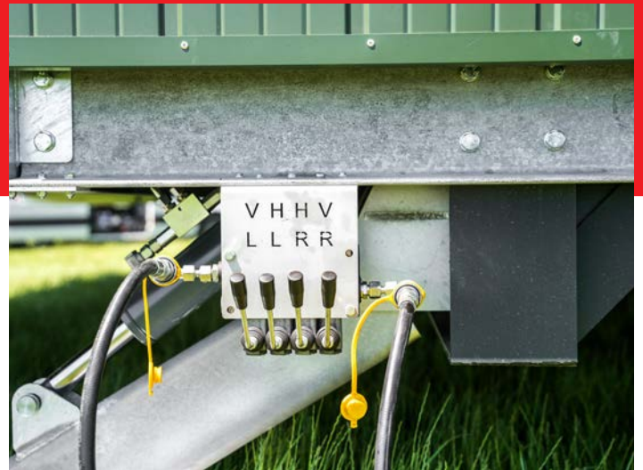
Pieds de support hydrauliques à commande individuelle
