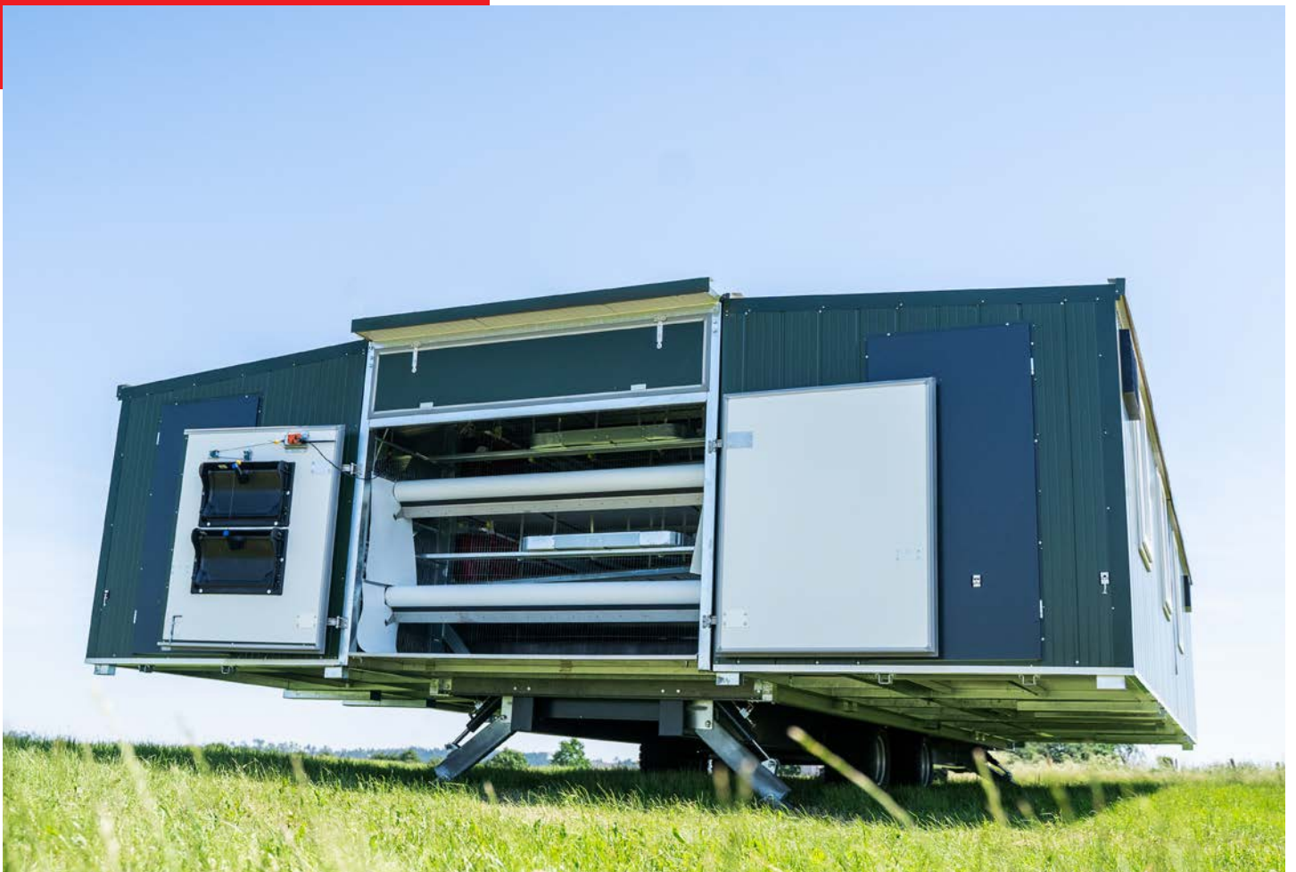
Deux tapis à fiente à entraînement électrique pour un enlèvement confortable du fientes
