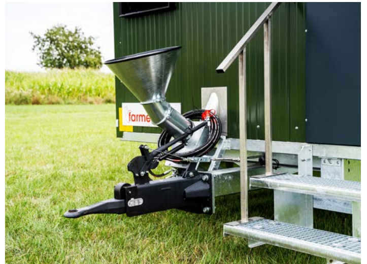
Trémie de remplissage et timon à freinage par inertie
