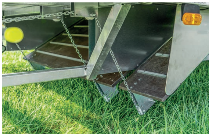
Trappes de sortie/entrée électriques et automatisées, vue extérieure
