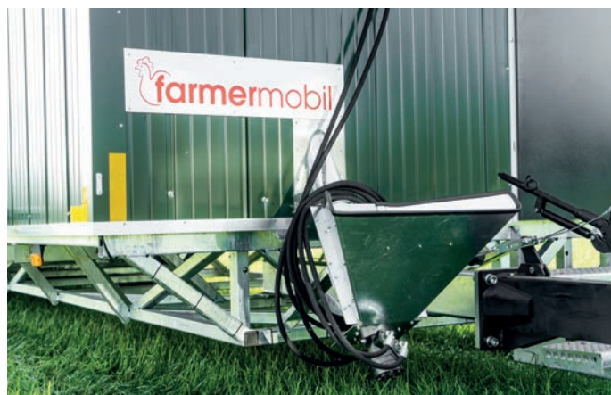
Trémie de remplissage pour le silo d'aliments
